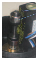
Detektionsscheibe und Schaltnocken für offenes Ventil
